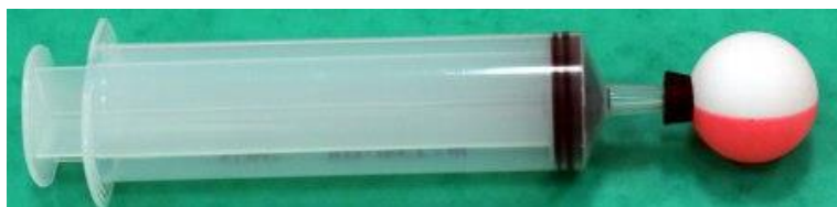
2 сурет – Сұйық және газ қысымын демонстрациялауға арналған құрал (Паскаль шары)
