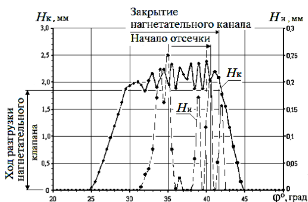
Рис. 1. Зависимость перемещения иглы форсунки H_n и нагнетательного клапана H_k от угла поворота вала насоса \varphi : n_n = 200 \text{ мин}^{-1}
