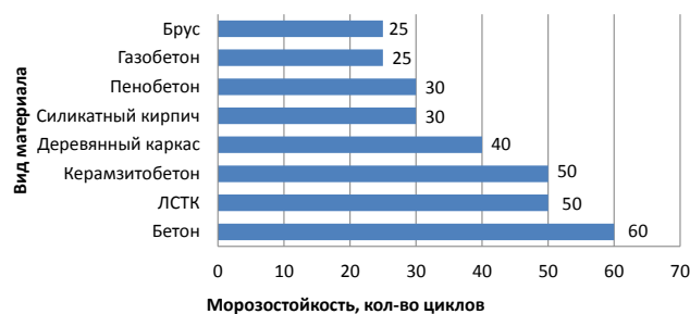
Рис. 6. Морозостойкость, количество циклов
