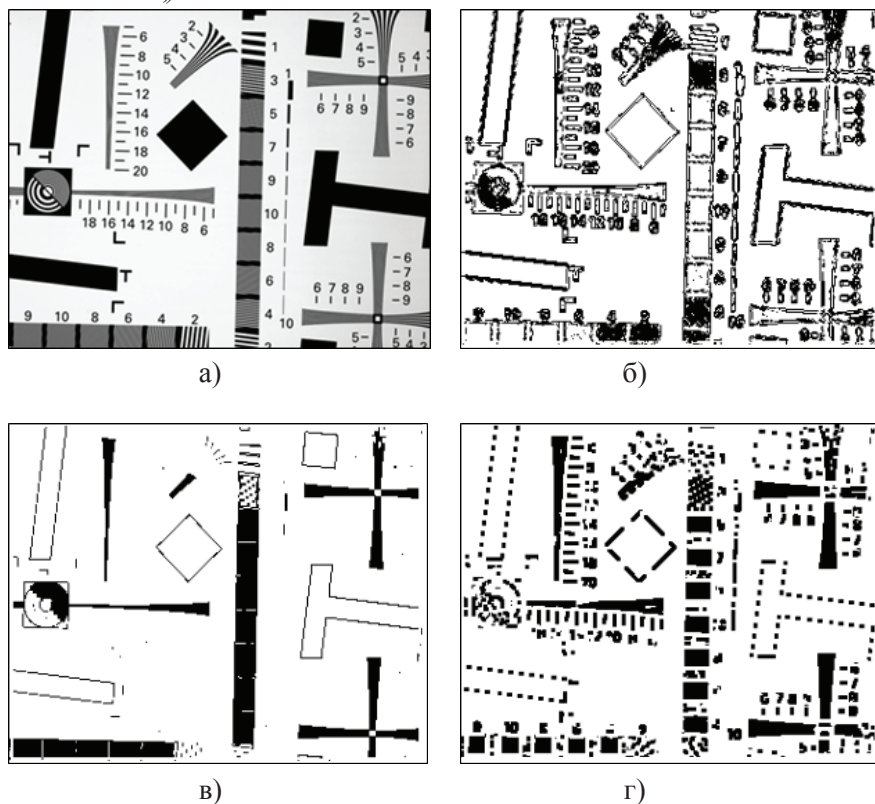
Рис.: 1. а) еталонне зображення; карта експонент Гельдера (для n = 9 ) еталонного зображення при використатті різних емоностей Шоке, відповідно б) \mu_{iso} ( \delta=11, 0<h<=0.6 ); в) \mu_{max} ( \delta=11, -0.36<h<=0 ); г) \mu_{min} ( \delta=11, -0.36<h<=0.2 ).
