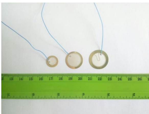
Рис. 4.2. Асиметричні п'єзокерамічні перетворювачі фірми muRata, що досліджувалися в роботі: 1 – елемент 7ВВ-12-9; 2 – елемент 7ВВ-20-3; 3 – елемент 7ВВ-20-6С
