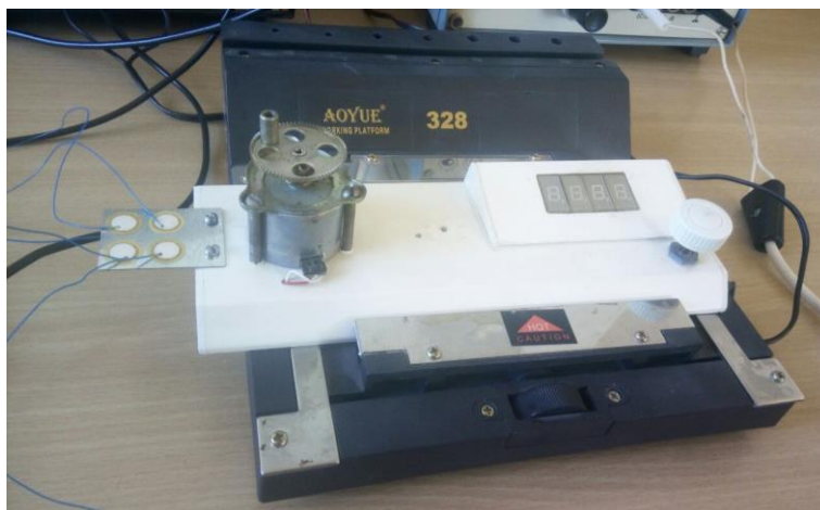
Рис. 4.9. Конструкція експериментальної платформи для дослідження впливу вібрації
