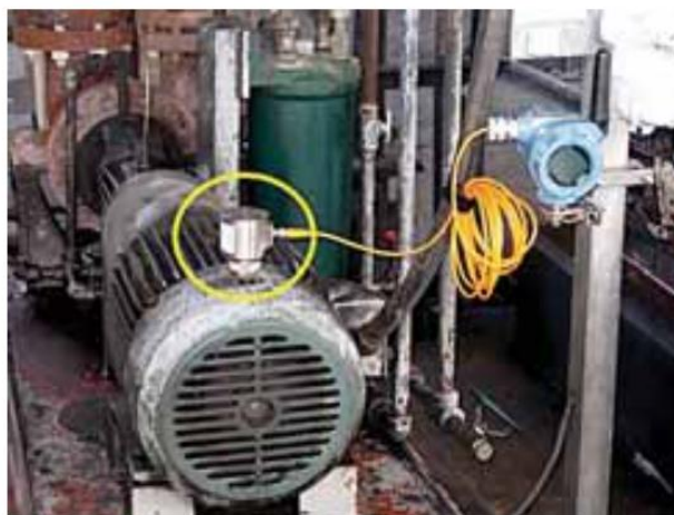
Рис. 4.20. Установка віброгенератора Vulture на промисловому двигуні [18]
