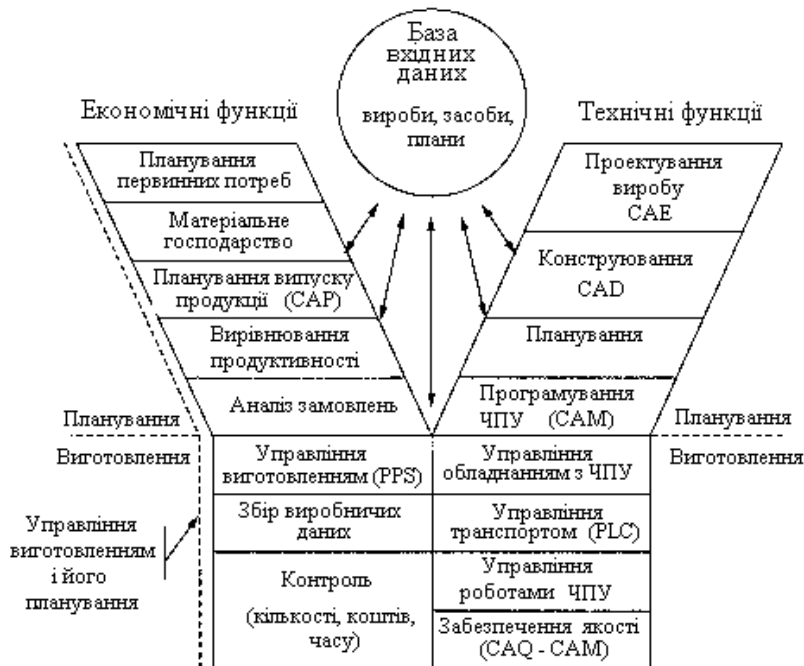
Рис.2. Модель ощадливого комп'ютерно-інтегрованого виробництва СІМ
