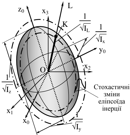
Рис. 6. Геометрична інтерпретація випадкового тензора інерції вібробункера у вигляді еліпсоїда інерції
