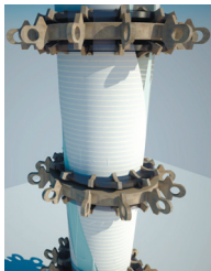
Рис. 3 Модель «Біотектона» 2015-17рр : а – схема розрізу концептуального рішення; б – схеми розрізу вузлів стебла пшениці – пружних шарнірів (демпферів); в, г – модель демпфера в «Біотектоні»; д – загальний вигляд демпферів в структурі «Біотектона».
