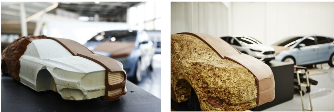
Рис. 10. Виготовлення пластилінових макетів Ford Mondeo III з використанням болванок.
