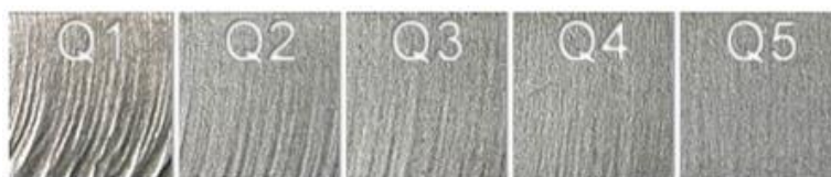
Рис. 1 - Збільшення сліду від гідроабразивного струменя при збільшенні швидкості різання
