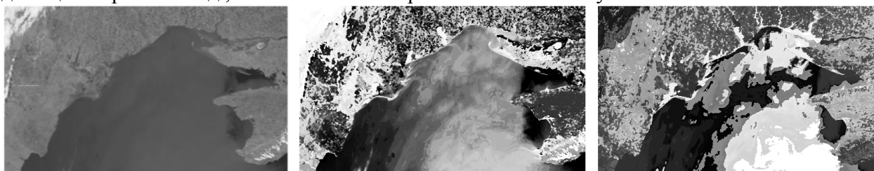
Рисунок 1 – Сегментация космоснимка: а – исходное изображение в уровнях серого; б – SOM; в – SOM по фазовым характеристикам SVD
