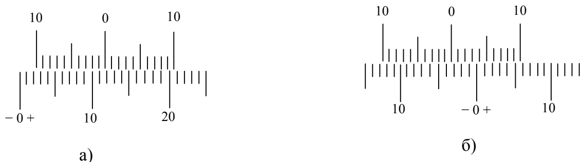
Рисунок 5.3.2 – Положення шкали і ноніуса в сахариметрі-поляриметрі при різних відліках: +11,8 (а) і -3,2 (б)
