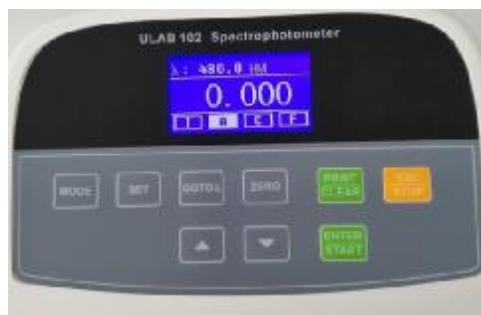
Рисунок 5.1.5 – Вигляд цифрового екрану спектрофотометра ULAB 102 при виборі функції «A» – вимірювання оптичної густини
