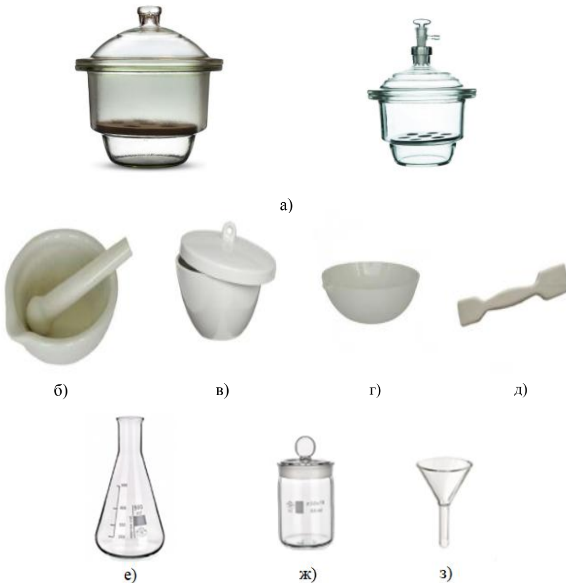
Рисунок 3.1.7 – Посуд для виконання гравіметричного аналізу:
