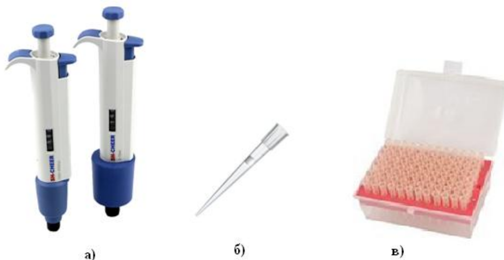
Рисунок 4.1.8 – Мікропіпетки (а); наконечник для мікропіпетки (б); бокс для зберігання наконечників (в)
