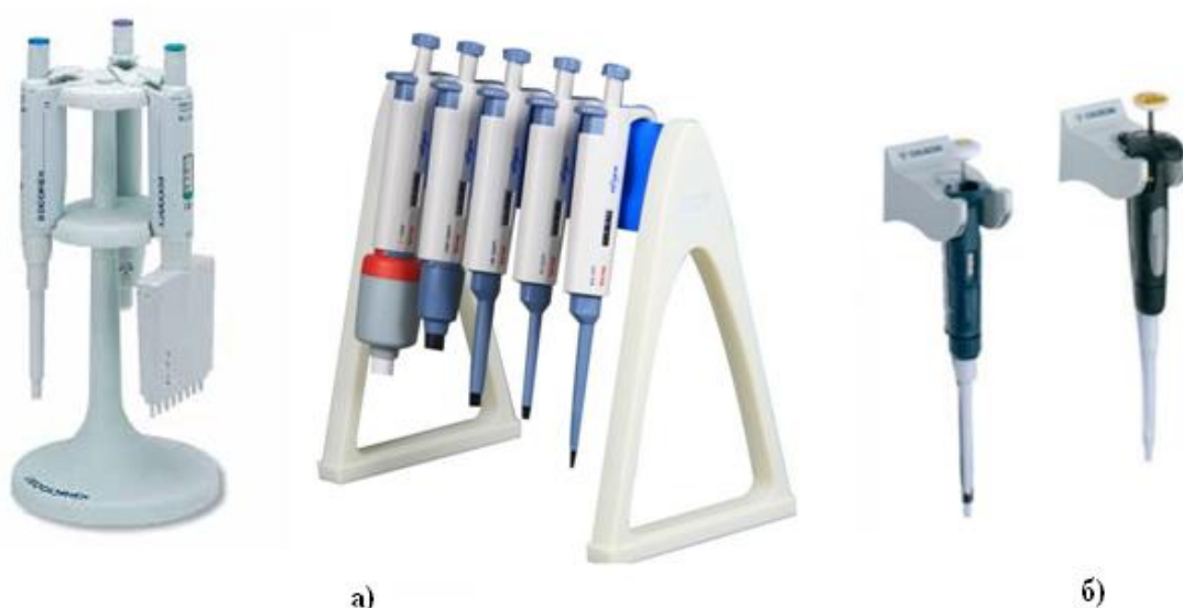
Рисунок 4.1.9 – Спеціальні штативи для мікропіпеток: а) настільні; б) настінні
