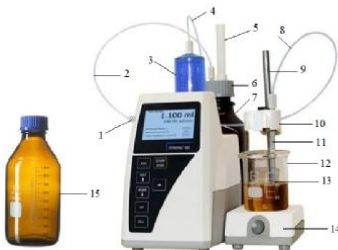
Рисунок 6.1.4 – Будова автоматичного титратора TitroLine 5000:
