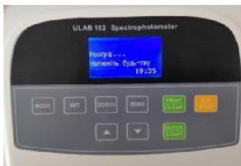
Рисунок 5.1.4 – Вигляд цифрового екрану спектрофотометра ULAB 102 при розігріванні пристрою
