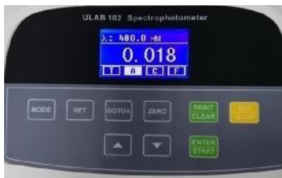
Рисунок 5.1.7 – Вигляд цифрового екрана спектрофотометра ULAB 102 з результатом вимірювання оптичної густини
