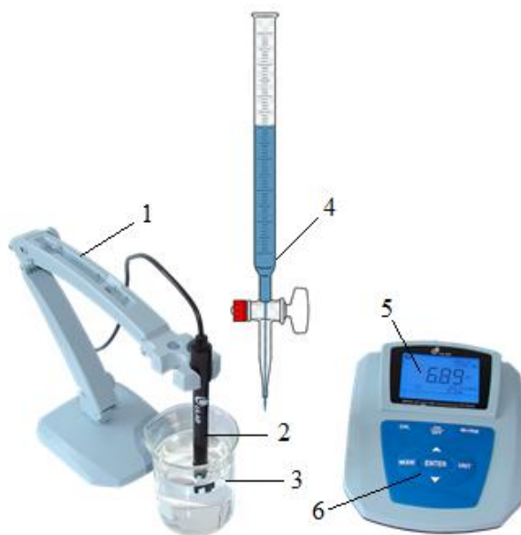
Рисунок 6.2.2 – Схема кондуктометра лабораторного МР 521:
