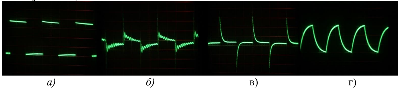
Рис. 25. Осцилограми сигналів п'єзоелектричного трансформатора а) вхідний сигнал (меандр); б) вихід 1; в) вихід 2; г) вихід 3
