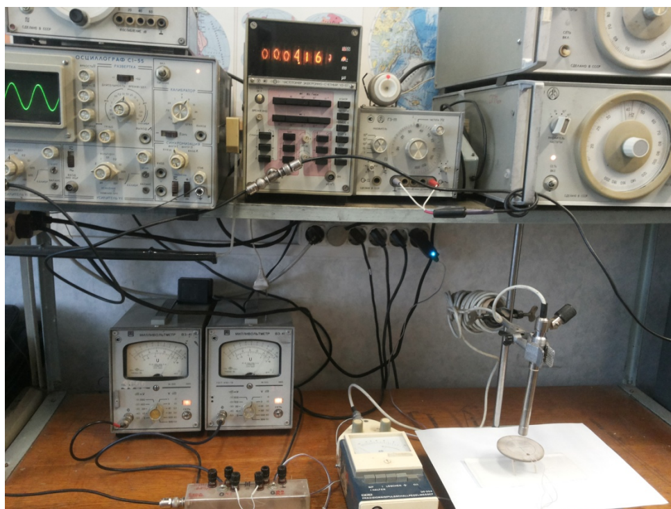
Рис. 6.43. Установка для дослідження п'єзоелектричних перетворювачів
