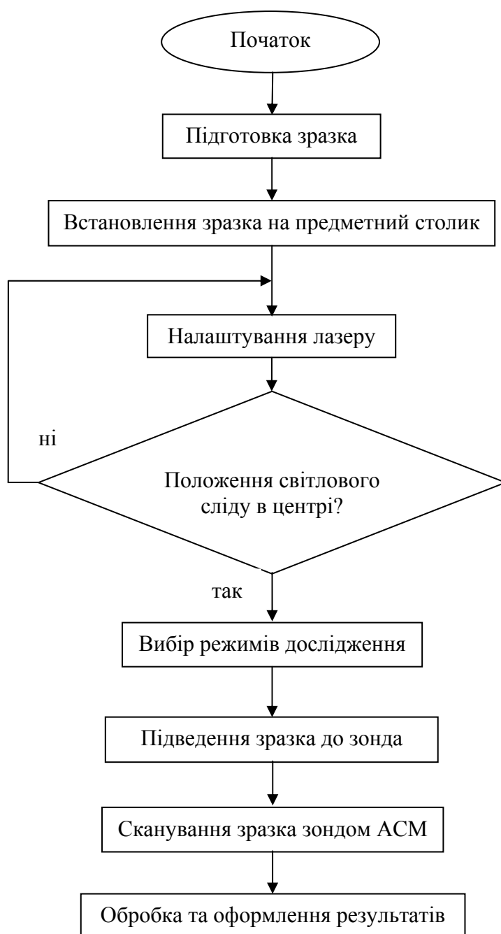
Рис. 6.5. Алгоритм проведення дослідження нанорельєфу методом АСМ
