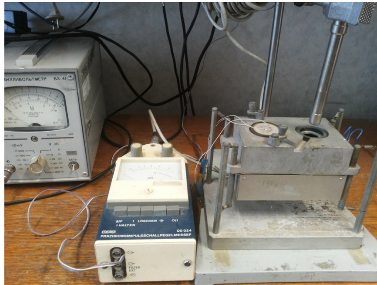
Рис. 5.21. Дослідний стенд з віброакустичною камерою
