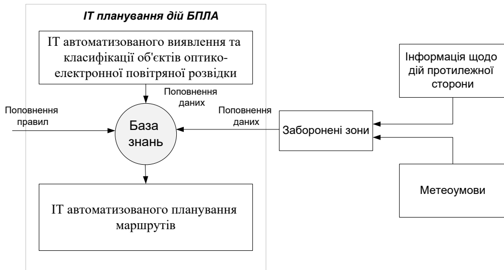
Рисунок 5 – Загальна структура знанняорієнтованої системи планування дій безпілотних літальних апаратів
