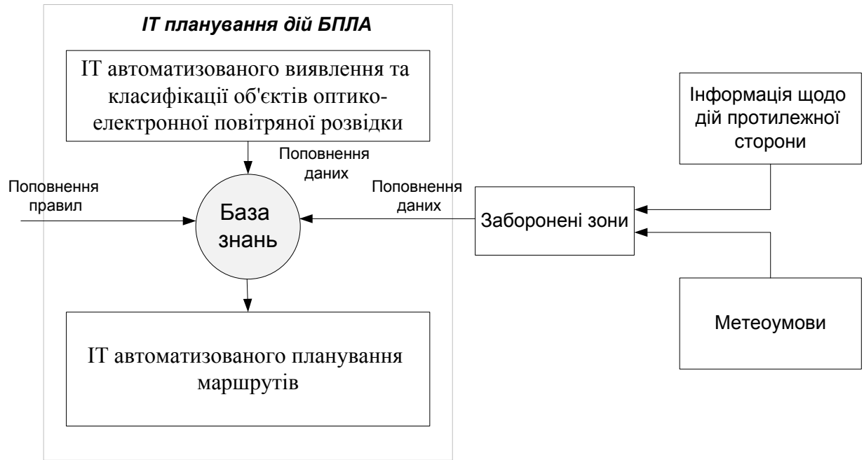
Рисунок 4.1 – Загальна структура знанняорієнтованої системи планування дій безпілотних літальних апаратів
