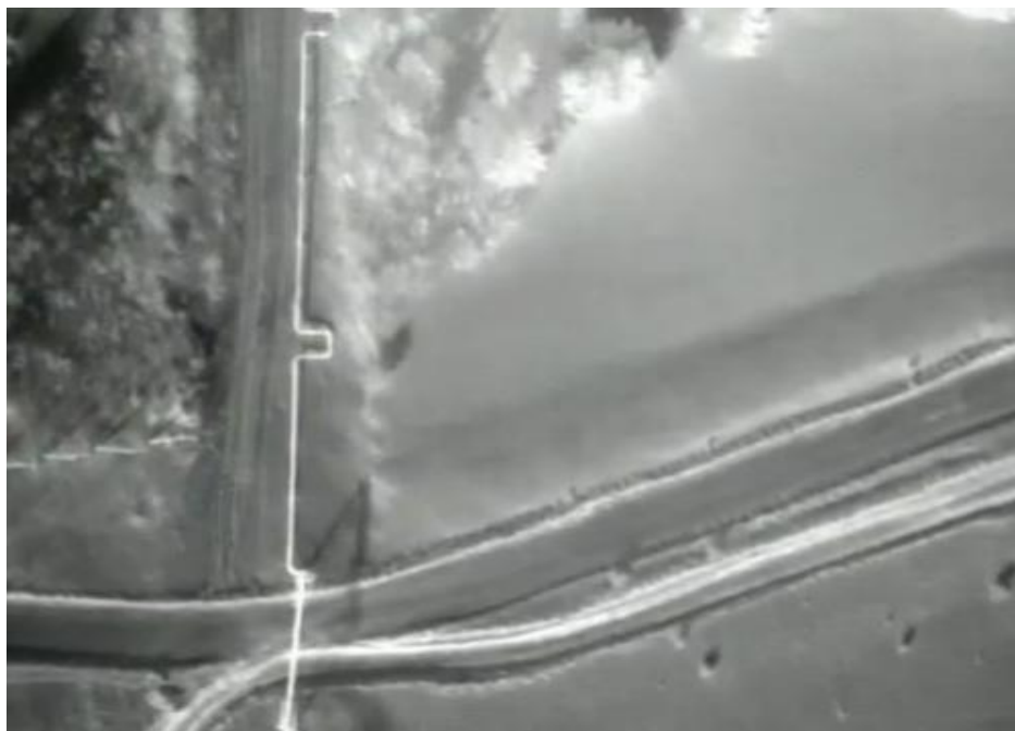
Рисунок 1.4 – Приклад фотознімку трубопроводу в інфрачервоному (ІЧ) діапазоні для визначення фактів незаконного врізання
