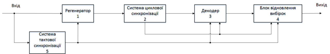
Рис. 4.2. Структурна схема декодера мовленнєвого сигналу з відновленням перестановок методом інтерполяції
