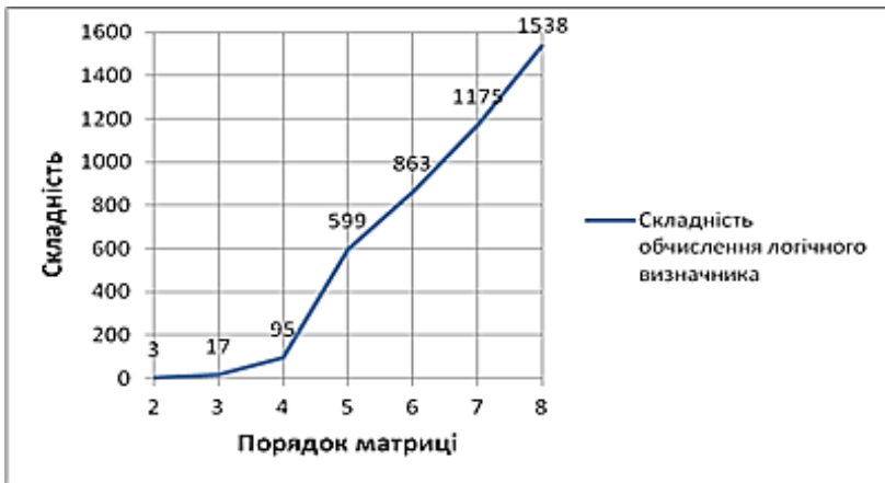
Рис. 1. Залежність складності обчислення логічного визначника моделі операції матричного криптографічного перетворення від порядку матриці
