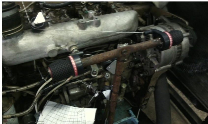
Рисунок 3.9 - Управління важелями паливоподачі в газодизельному режимі
