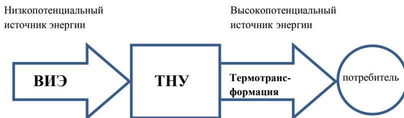
Рис. 2. Принципиальная схема преобразования энергии
