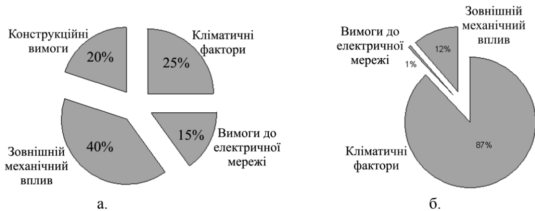
Рис. 1. Діаграми ступеню впливу вимог до конструкції автоматизованих систем АСМ-контролю на точність і надійність отриманих даних (а) та на економічність (б) застосування засобів захисту
