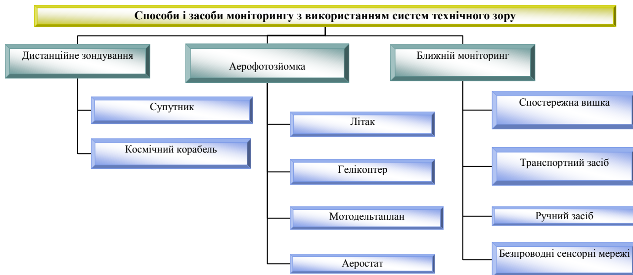
Рис. 1. Класифікація способів і засобів моніторингу агробіологічного стану сільськогосподарських угідь
