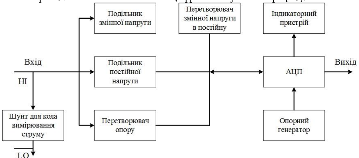
Рисунок 3.1 - Блок-схема цифрового мультиметра
