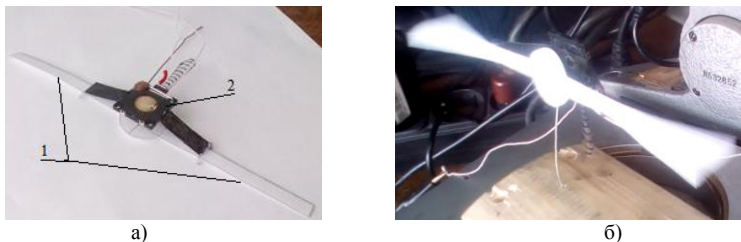
Рисунок 1 – Дослідний зразок розробленого повітряного мініробота: (а) конструкція робота; (б) робота крил в динаміці 1 – крила, 2 – повітряний актуатор
