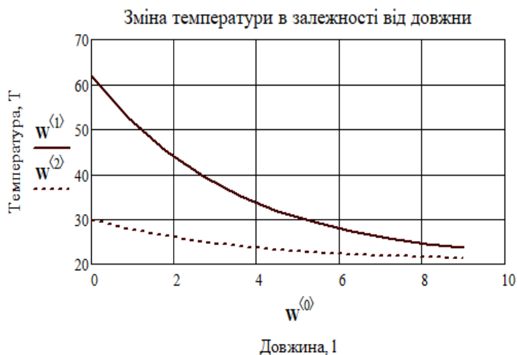
Рисунок 2.11 – Графік розподілу температур по довжині охолоджувальної камери
