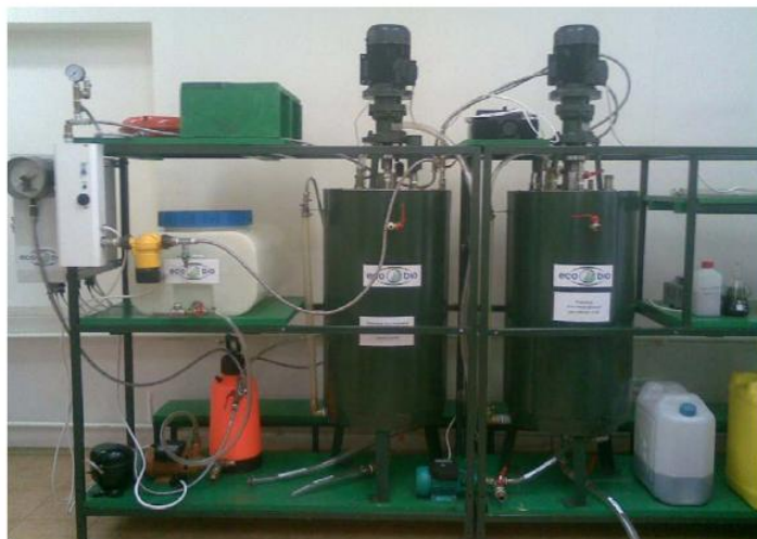
Рис. 1 – Експериментальна установка для виробництва біодизеля
