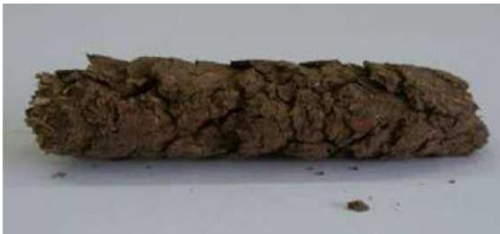
Рис. 4 – Зразок гранули, виготовленої з листя дуба при вологості 32%
