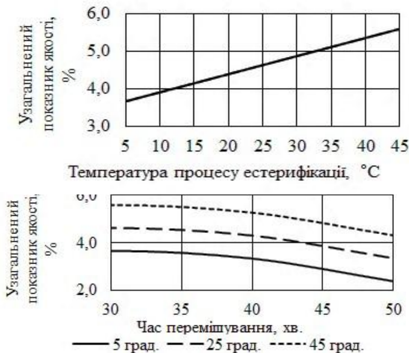
Рис. 2 – Залежність узагальненого показника якості дизельного біопалива від температури процесу естерифікації та часу перемішування
