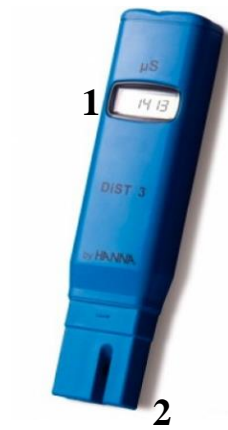
Рис.2.3 – Зовнішній вигляд приладу для визначення солоності ЕС-метр: 1 – електронний індикатор солоності (ppm); 2 – вимірювальні електроди
