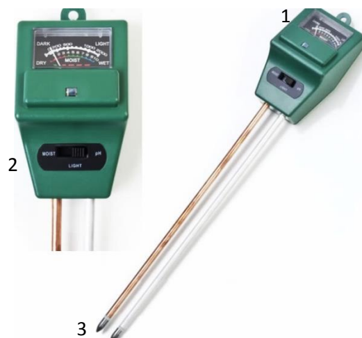
Рис. 2.2. Зовнішній вигляд приладу для визначення рівню pH ЕТР-303: 1 – аналоговий індикатор кислотності; 2 – перемикач режимів роботи приладу; 3 – вимірювальні електроди
