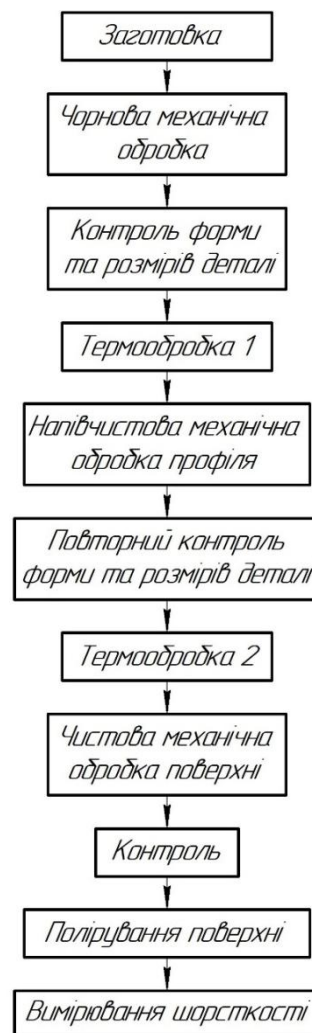
Рисунок 1 – Спрощена схема виготовлення ротора з алюмінієвих сплавів D16 та B95 за заданою шорсткістю
