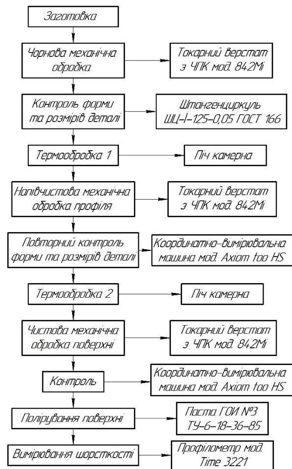
Рисунок 6 – Блок-схема виготовлення ротора з алюмінієвих сплавів Д16 та В95 за заданою шорсткістю
