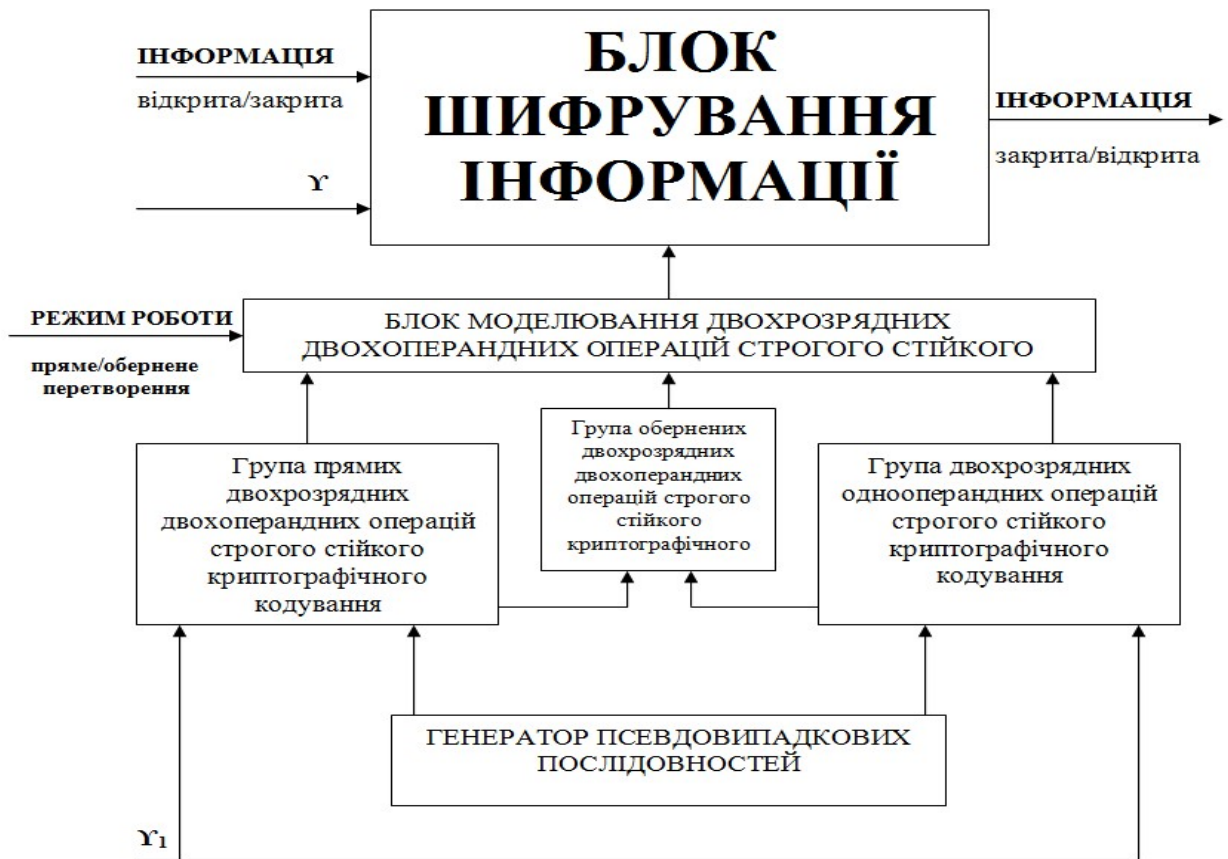
Рис. 2. Структурна схема удосконаленого методу підвищення стійкості та надійності потокового шифрування шляхом генерації псевдовипадкових послідовностей прямих та обернених операцій криптоперетворення
