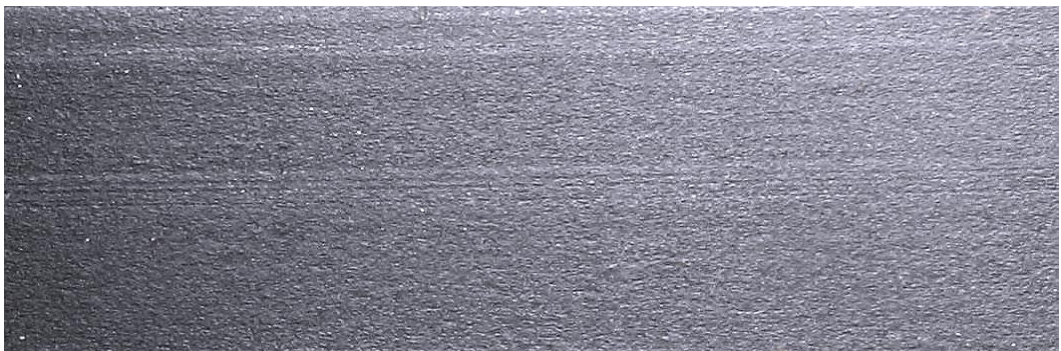
Рис. 3.17 – Фотознімок поверхні деталі, отриманої методом ЕЕДВ. ( \times 10 )
