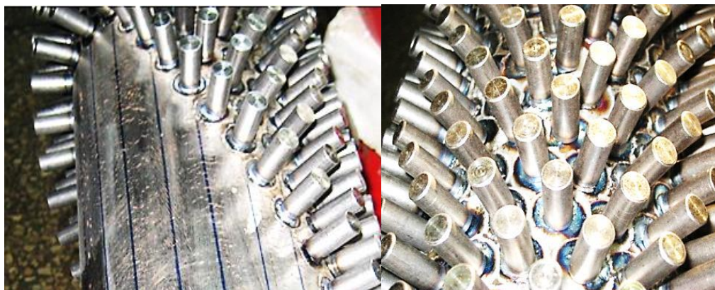
Рис. 3. Фрагменти труби (15X5M) з навареними шипами (сталь 20)
