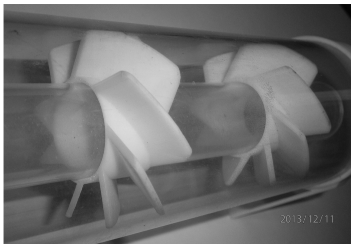
Рис. 1. Холодный аэродинамический стенд (физическая модель) для исследования струйно-вихревых процессов в рабочем пространстве рекуператора. Винтовые крыльчатки изготовлены методом 3D-печати из ABS-пластика [2]
