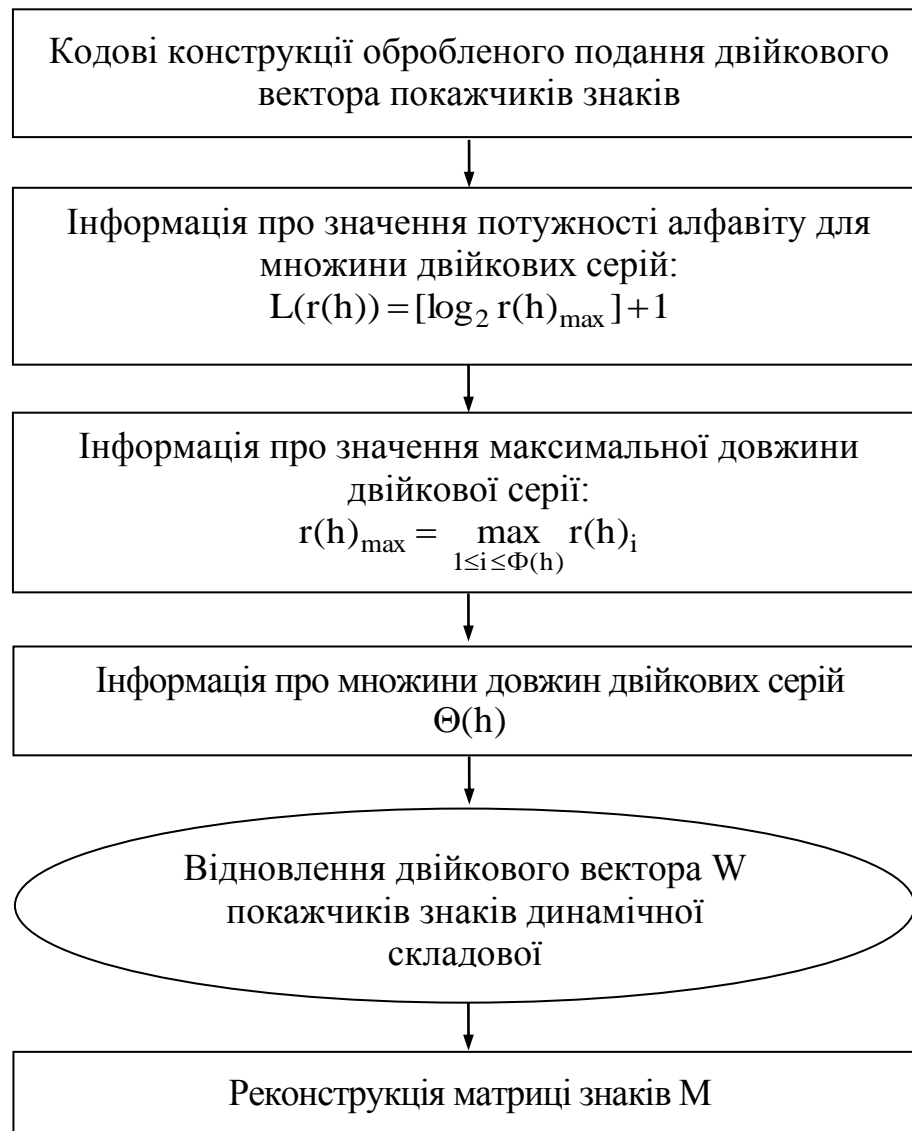
Рисунок 5.14 – Схема реконструкції двійкового вектора показчика знаків динамічної складової
