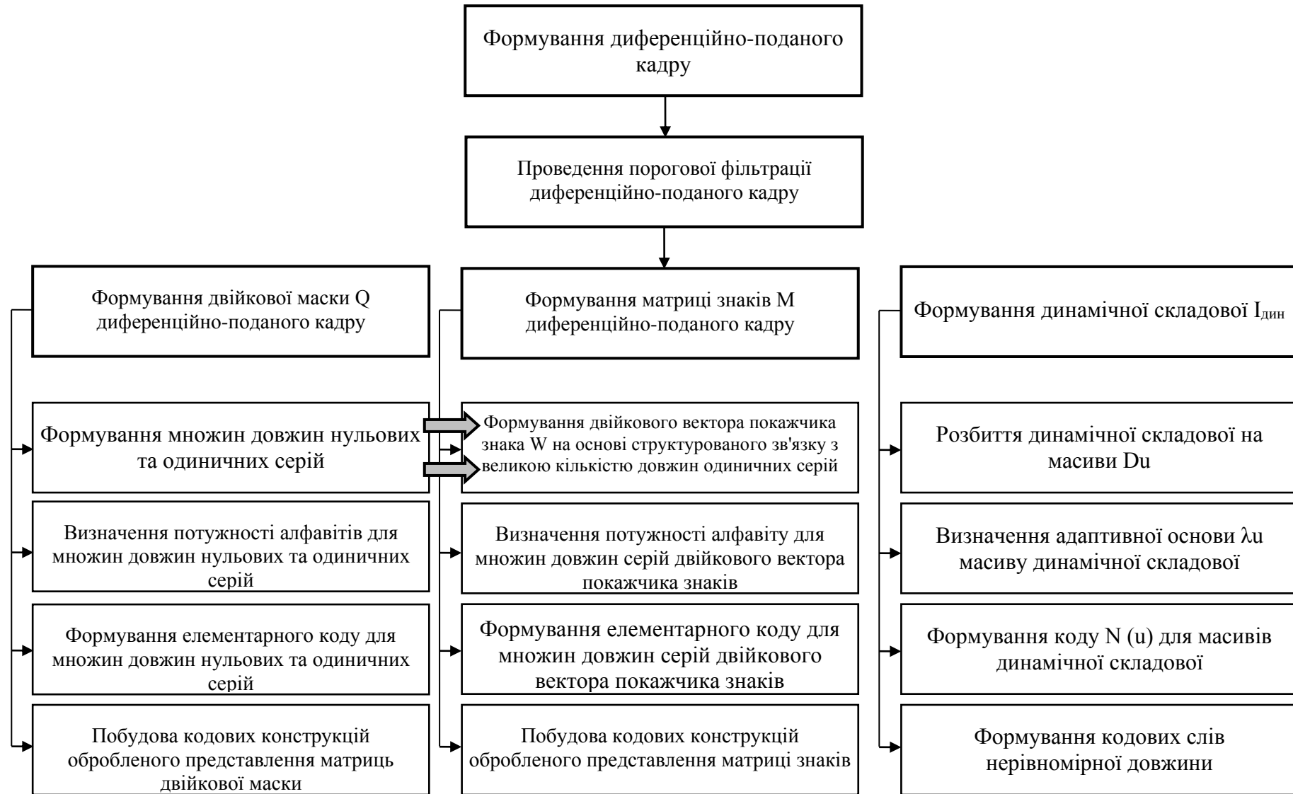
Рисунок 5.8 – Структурна схема побудови кодових конструкцій обробленого виду диференційно-поданого кадру
