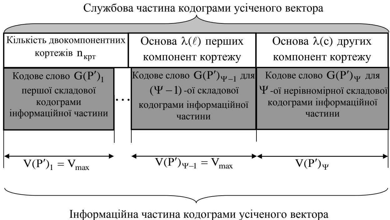
Рисунок 4.6 – Структура кодограми обробленого представлення усіченого вектора двокомпонентних кортежів
