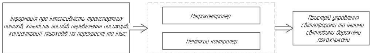
Рисунок 1.1 – Функціональна схема інформаційної системи управління світловими дорожніми показниками
