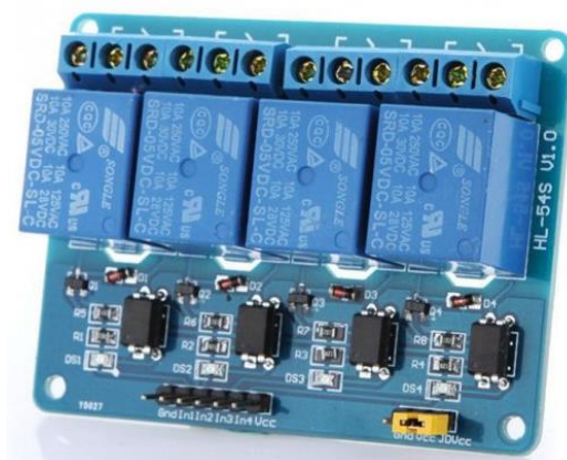
Рис. 4. Реле ввімкнення та вимкнення споживачів
