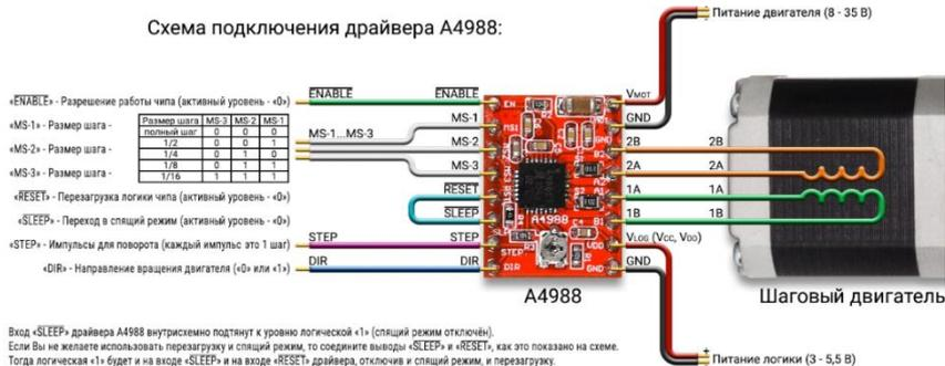
**Рис.4. Драйвер двигуна а4988**
