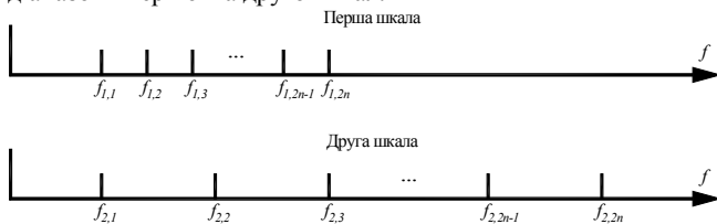
Рис. 1. Розташування частот першої та другої шкали багаточастотного фазового методу далекометрії
