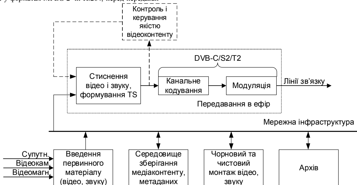
Рис. 1. Система, що ілюструє технологічний процес виробництва телепрограм
