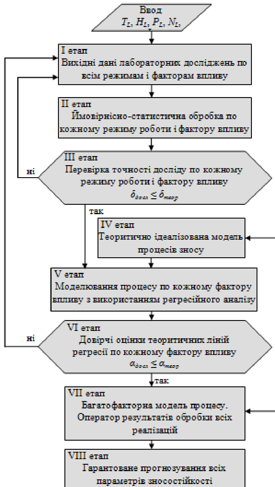
Рисунок 3.7 – Блок-схема обробки результатів випробувань, моделювання та прогнозування зносостійкості
