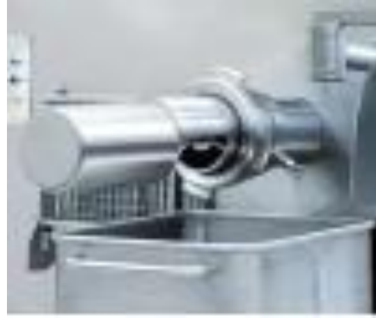
Рис. 1.8. Пристрій кінцевого різання Seydelmann: а) – ніж остаточного різання; б) – привод пристрою
