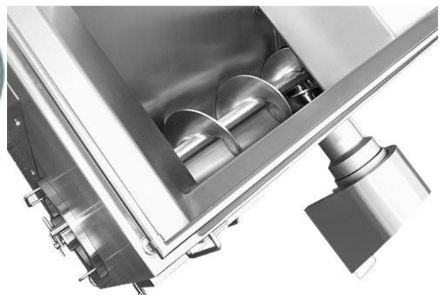
Рис. 1.18. Вовчок Karl Schnell Winkelwolf 160: а) – зовнішній вигляд вовчка; б) – подавальний шнек вовчка
