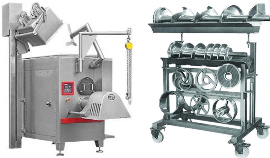
а) б) Рис. 1.34. Вовчок-дробарка Karl Schnell Automatenwolf V250 : а) – зовнішній вигляд вовчка-дробарки; б) – робочі органи вовчка
