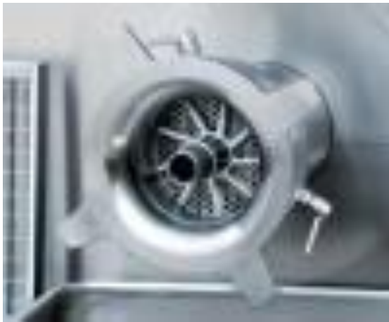
Рис. 1.8. Пристрій кінцевого різання Seydelmann: а) – ніж остаточного різання; б) – привод пристрою
