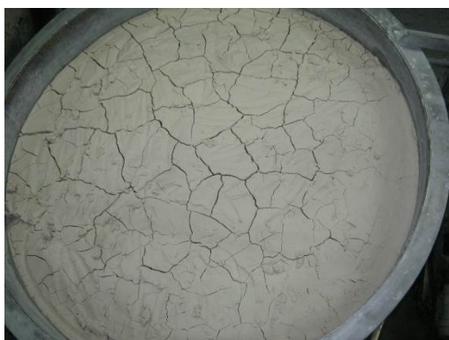
Рисунок 8 – Внешний вид карбонатного осадка цинка на фильтре
