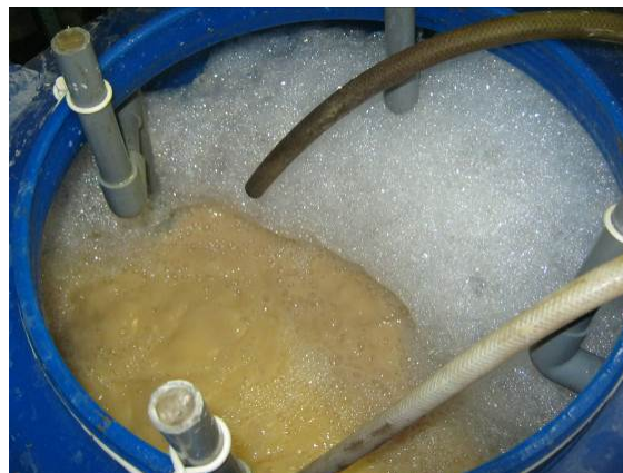
Рисунок 7 – Пульпа карбонизации (вид сверху)
