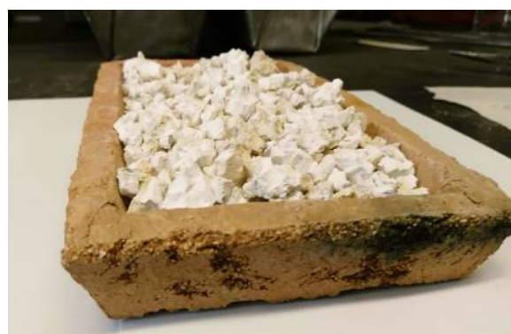
Рисунок 9 – Карбонатный цинковый осадок перед обжигом
