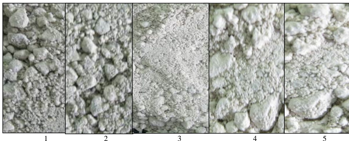
Рисунок 10 – Фотографии обожжённого карбонатного цинкового осадка
