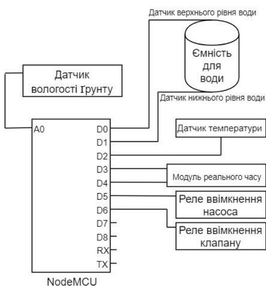
Рисунок 2 – Загальна схема мікроконтролерної системи
