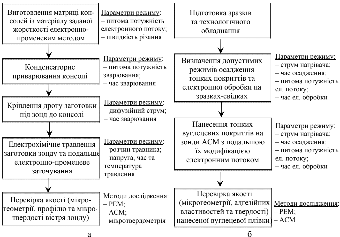
Рис. 8. Технологічна схема виготовлення наноінструменту для АСМ: а – повний технологічний цикл; б – модифікація стандартного інструментарію
