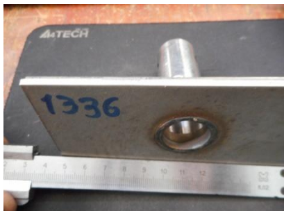
Рисунок 6 – Фотографія з'єднання типу «пластина-труба» після лазерного зварювання
