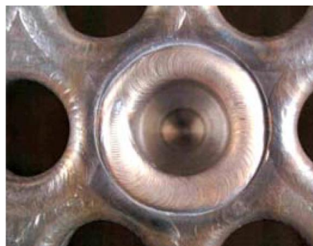
Рисунок 4 – Заглушка встановлена із застосуванням аргонодугового зварювання [24]
