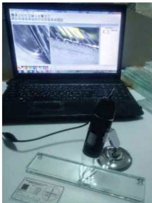
Рис. 3. Загальний вигляд установки для дослідження поверхні скла.
