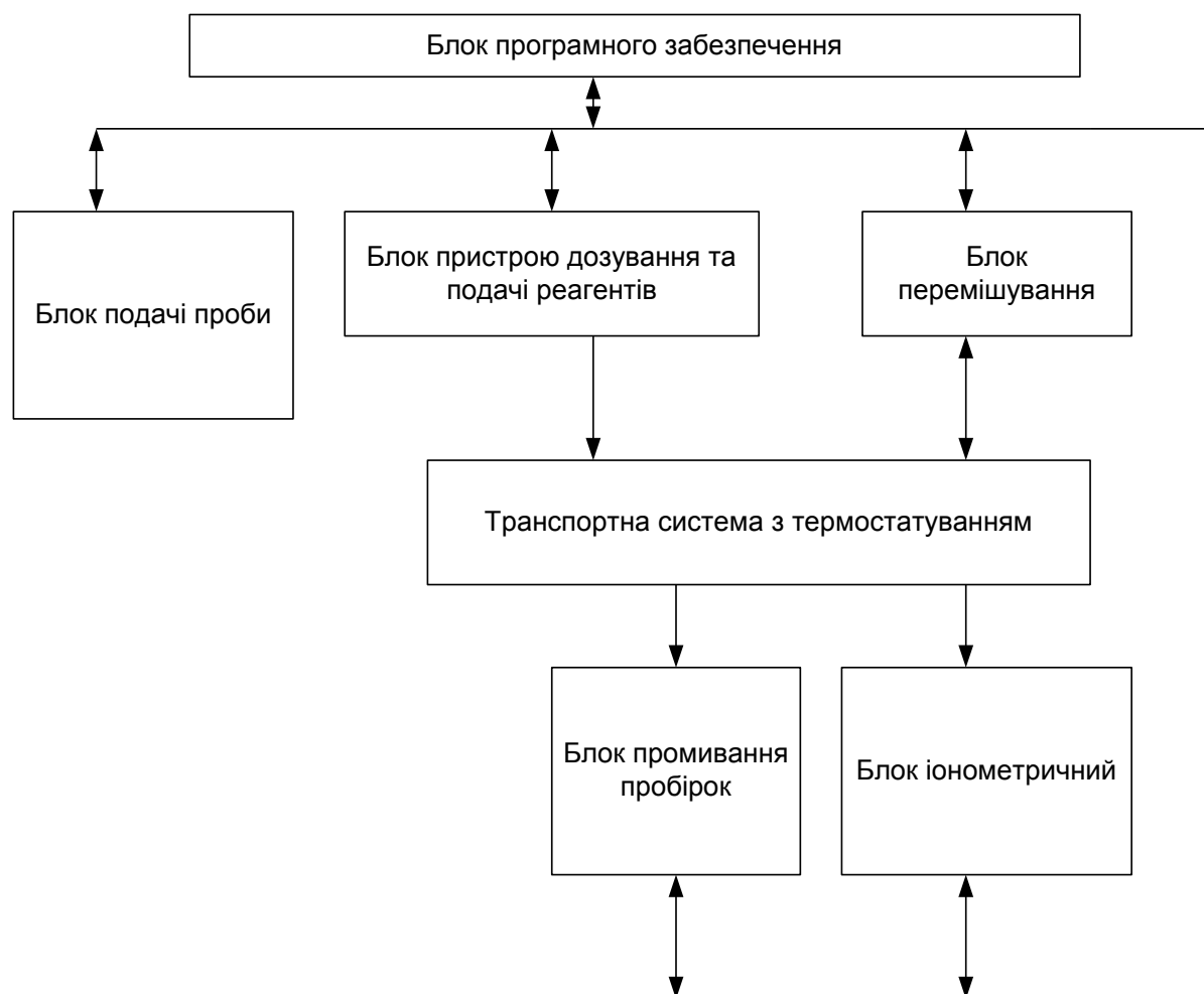
Рисунок 1.1 - Образно-знакова модель первинного перетворювача інформації для автоматичного іонометричного аналізу
