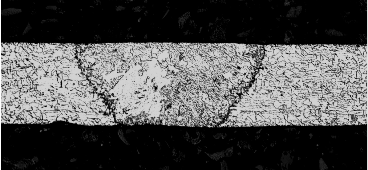
Рис. 3.5. Макроструктура шва, отриманого при частоті модуляції 1000 Гц
