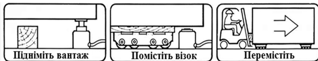
Рис. 7. Принцип використання такелажних візків для переміщення великогабаритного та великовагового вантажу
