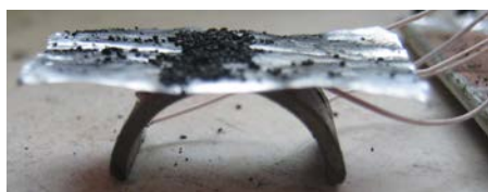
Рис. 10. Определение формы колебания пьезоэлемента при помощи фигур Хладни
