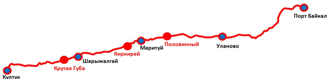
Рисунок 9 – Схема Кругобайкальской железной дороги (перспективная, после предлагаемой реконструкции, открываемые разъезды обозначены красным цветом)
