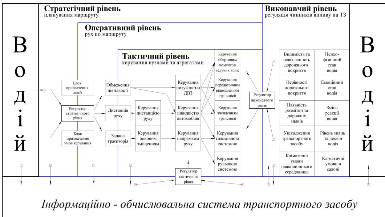
Рисунок 2 – Структурна схема розподілу сигналів керування транспортним засобом
