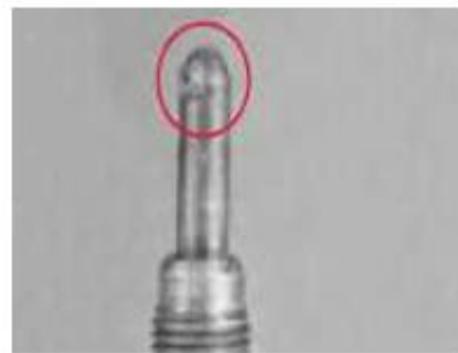
Надмірне розжарювання Несправність генератору чи регулятора
