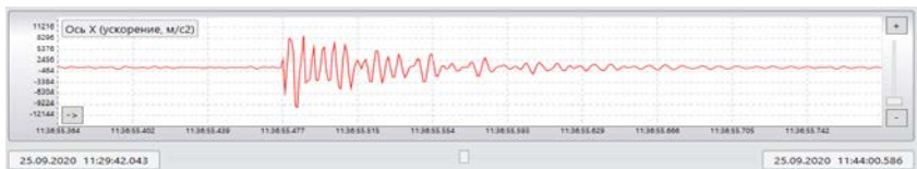
Рис. 2. Сигнал тріщини в шахті ЗЖРК
