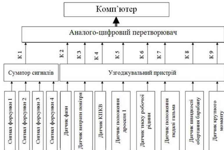
Рисунок 2 – Схема підключення датчиків та виконавчих пристроїв двигуна і стенда до системи збору даних
