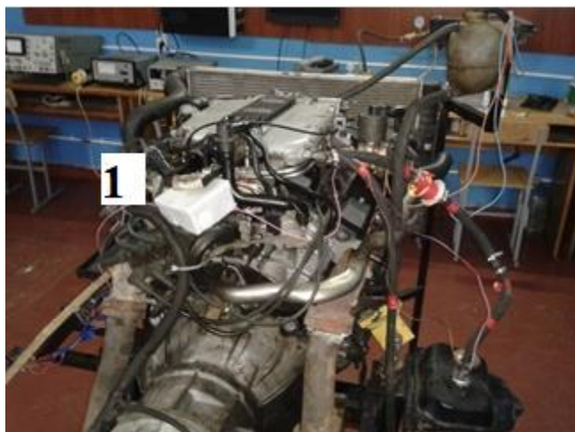
Рисунок 4 – Двигун автомобіля Opel Omega 3.0 V6 з встановленим блоком управління системи керування форсунок (1).
